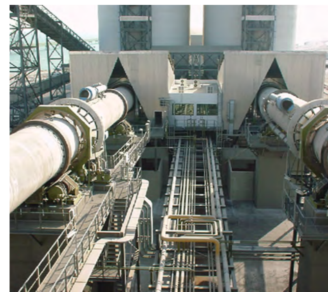
Две установки обжига кокса производительностью 250 000 млн т/год с вращающимися печами
